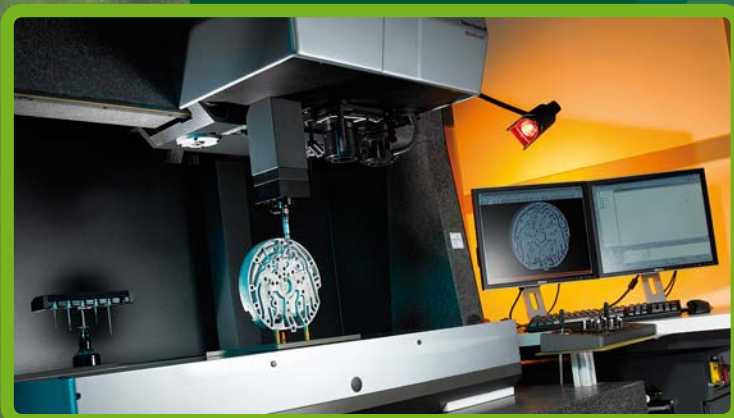
Zoomoptik, Laser und taktile Taste auf Wert Werth Video-Check-IP-800 3D CNC
