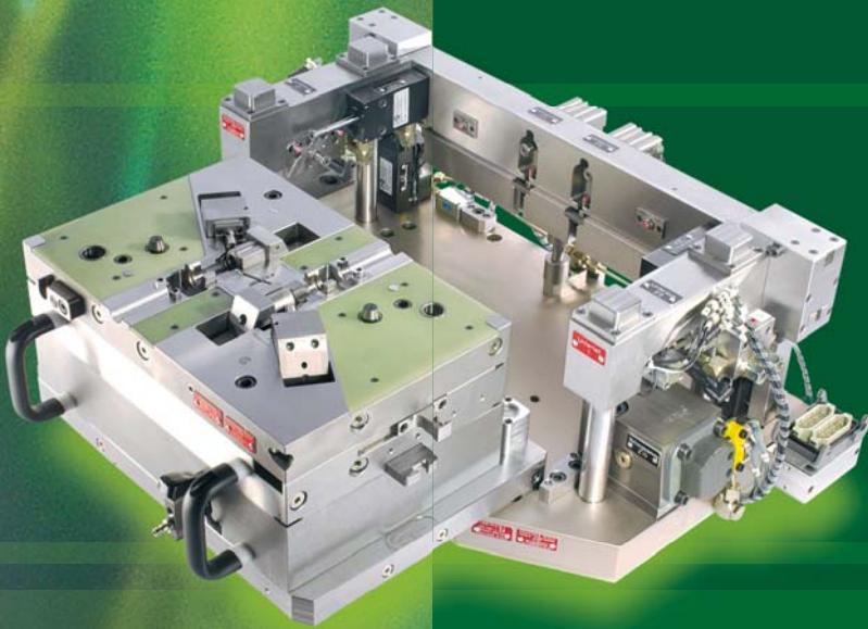
Werkzeugunterteil mit Walther Wolf-Aufspanneinheit
